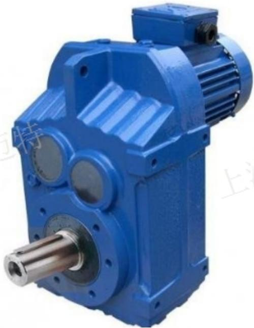
齿轮箱是机械传动中广泛应用的重要部件，一对齿轮啮合时，由于不可避免地存在着齿距、齿形等误差，在运转过程中会产生啮合冲击而发生与齿轮啮合频率相对应的噪声，齿面之间由于相对滑动也发生摩擦噪声。由于齿轮是齿轮箱传动中的基础零件，降低齿轮噪声对控制齿轮箱噪声十分必要。一般来说，齿轮系统噪声发生的原因主要有以下几个方面：齿轮设计方面。参数选择不当，重合度过小，齿廓修形不当或没有修形，齿轮箱结构不合理等。齿轮加工方面基节误差和齿形误差过大，齿侧间隙过大，表面粗糙度过大等。齿轮系及齿轮箱方面。装配偏心，接触精度低，轴的平行度差，轴，轴承、支承的刚度不足，轴承的回转精度不高及间隙不等。其他方面输入扭矩。负载扭矩的波动，轴系的扭振，电动机及其它传动副的平衡情况等。
